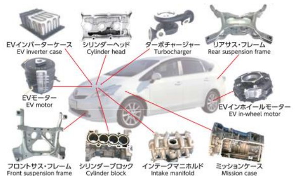
3Dプリンタによる自動車部品試作への適用例
